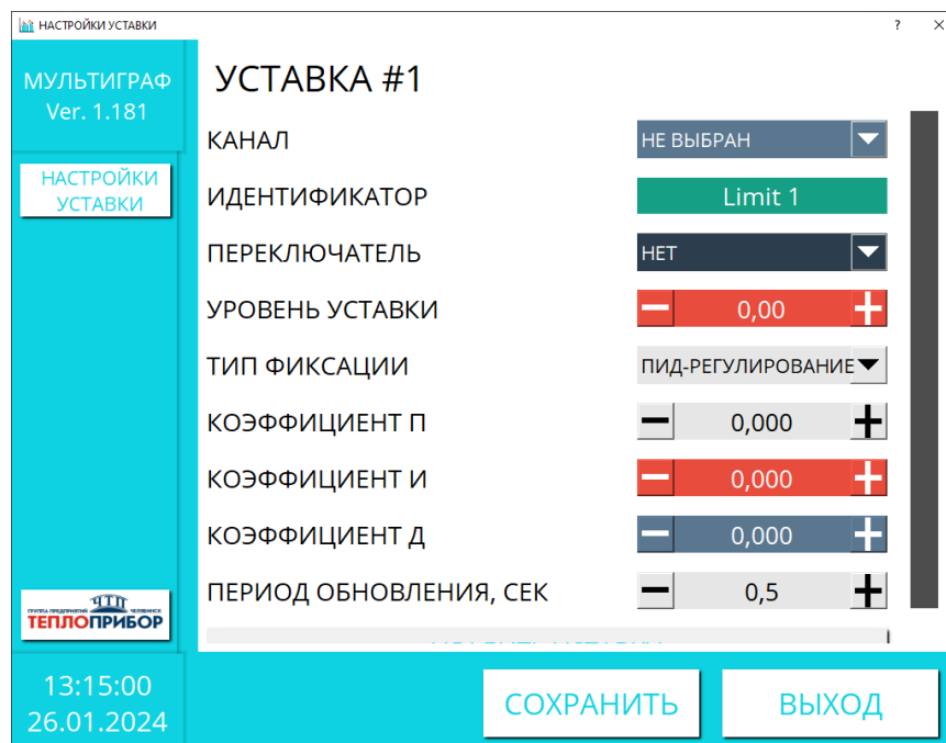
Рисунок 2.41 – Настройка уставки для канала в режиме ПИД-регулятора
