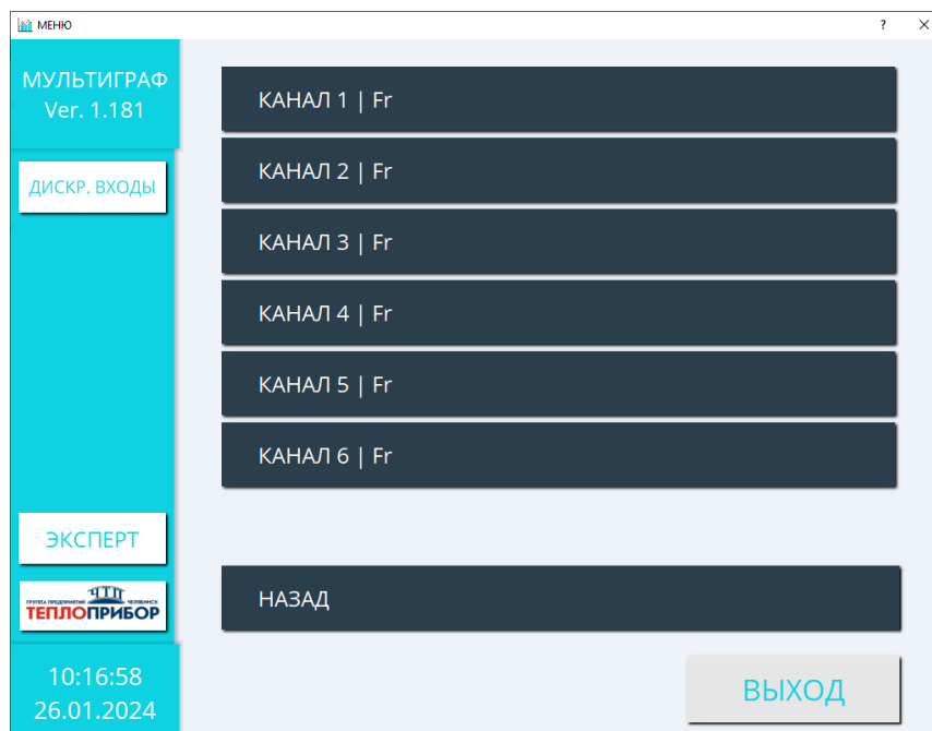
Рисунок 2.18 – Меню настройки частотных (дискретных) входов
