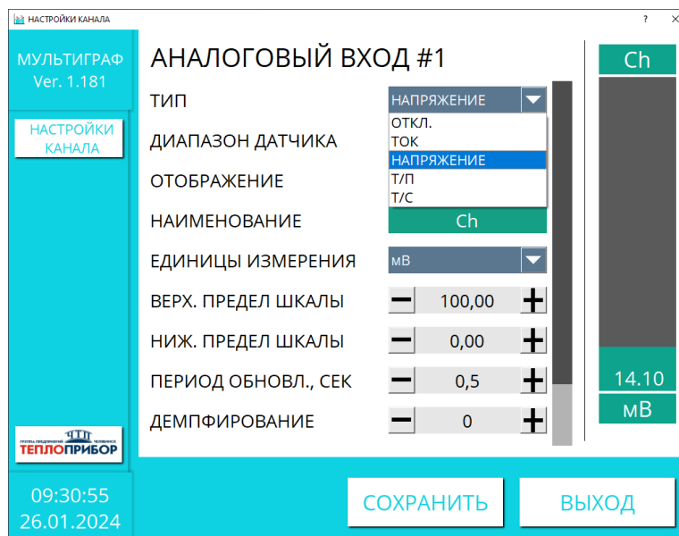
Рисунок 2.9 – Выбор типа измеряемых сигналов
