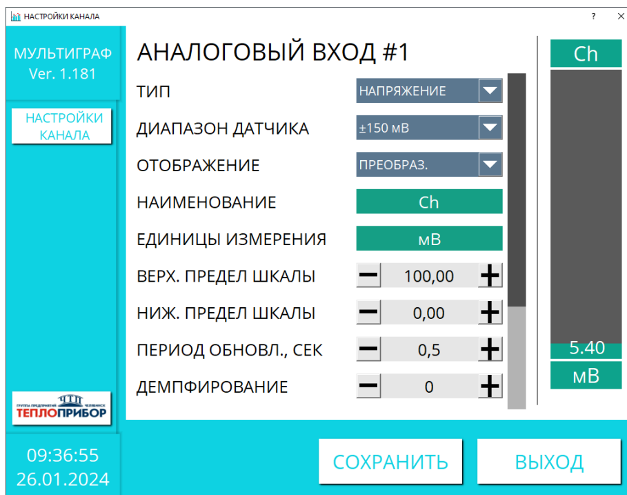
Рисунок 2.14 – Настройка единиц измерения в режиме напряжения
