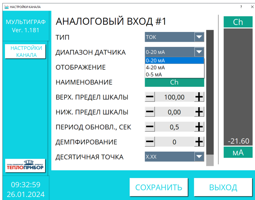
Рисунок 2.10 – Параметры настройки входа токового сигнала
