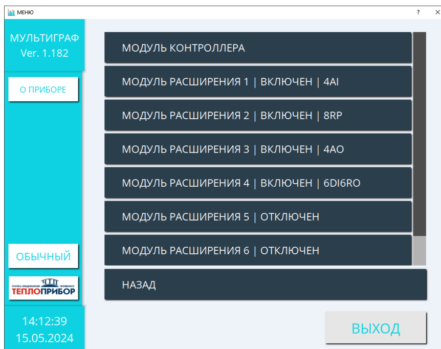
Рисунок 2.62 – Список используемых слотов
