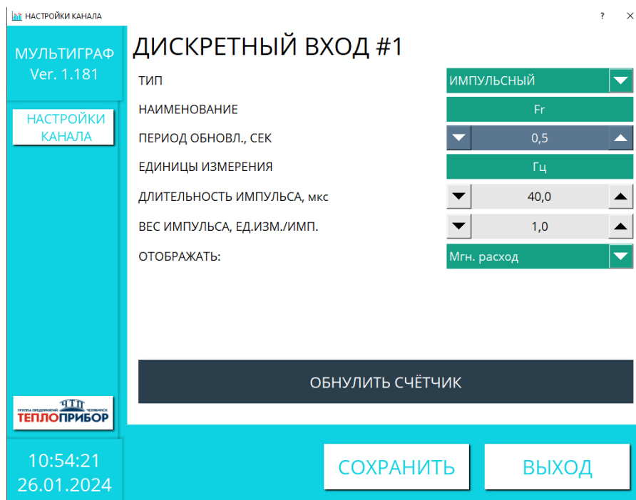
Рисунок 2.27 – Настройка канала в режиме работы «ИМПУЛЬСНЫЙ»
