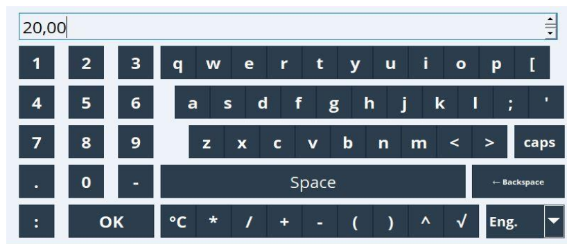
Рисунок 1.3 – Виртуальная клавиатура «Мультиграф»
